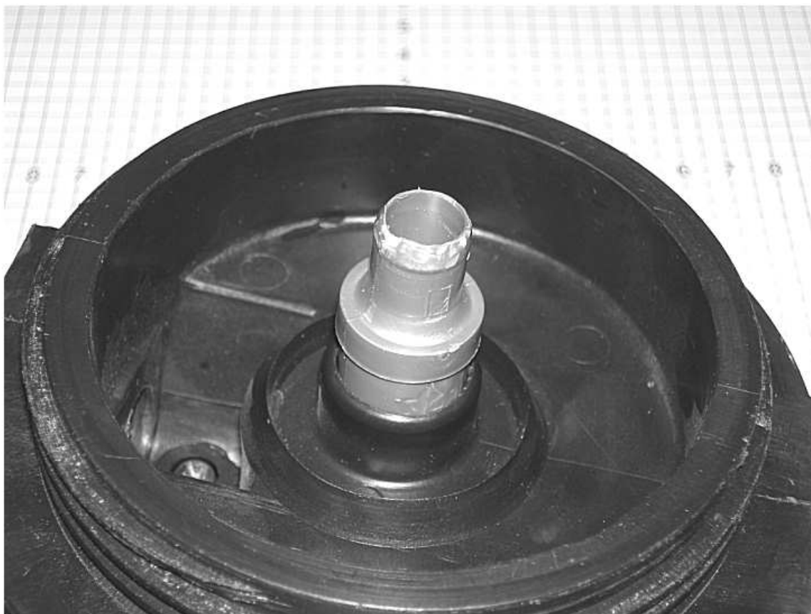
Figura 3: Detalle del ajuste del conector de mangueras (ya alterado) en el orificio de salida de agua de la tapa del soporte.
