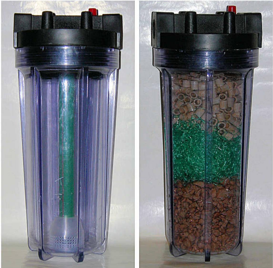
Figura 5: Vista final del soporte con el accesorio montado. A la izquierda sin material filtrante, y a la derecha con el material filtrante completo de un filtro de botella para 100-300 litros de una conocida marca de filtros profesionales. El ingreso de agua es por la parte superior.
