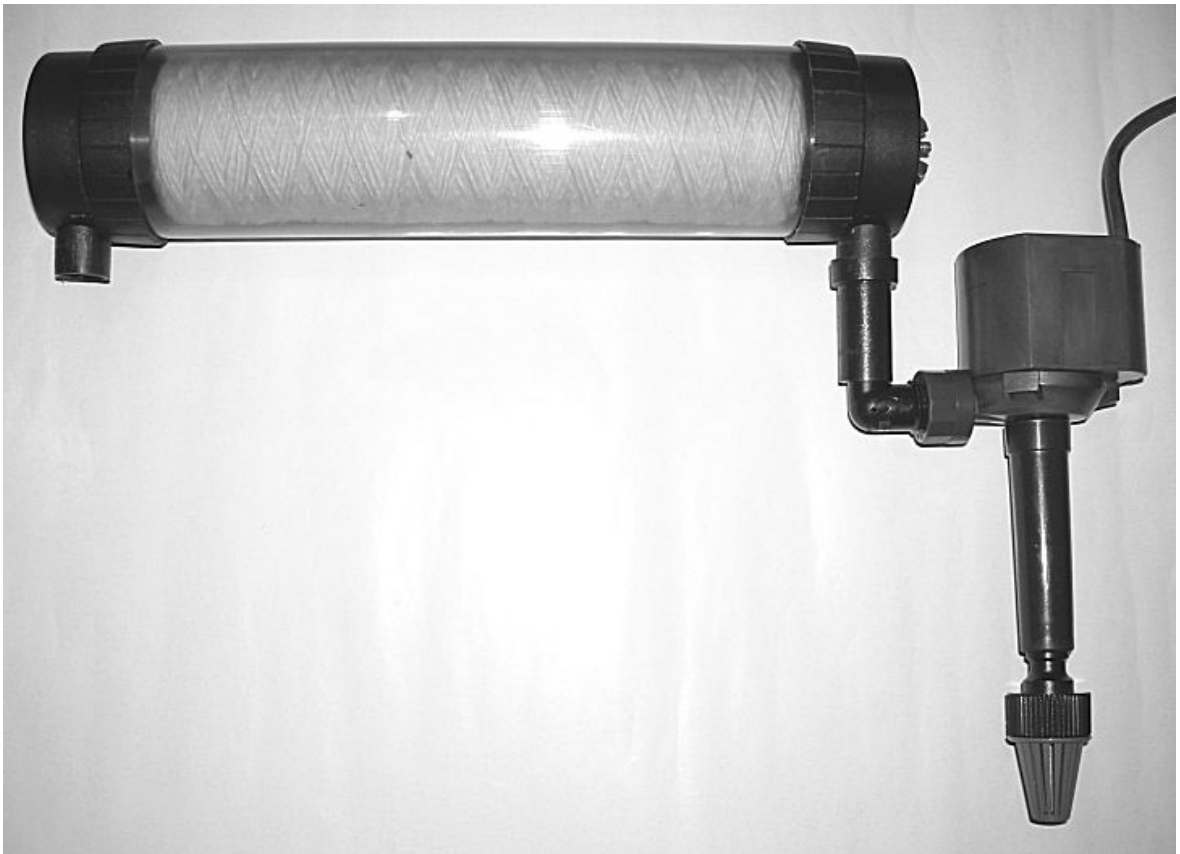
Figura 4: Soporte completamente ensamblado para mostrar la disposición del cartucho filtrante y la bomba impelente
