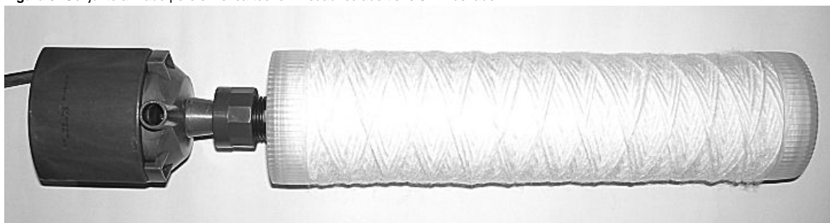
Figura 4: Filtro terminado con bomba y cartucho instalados.
