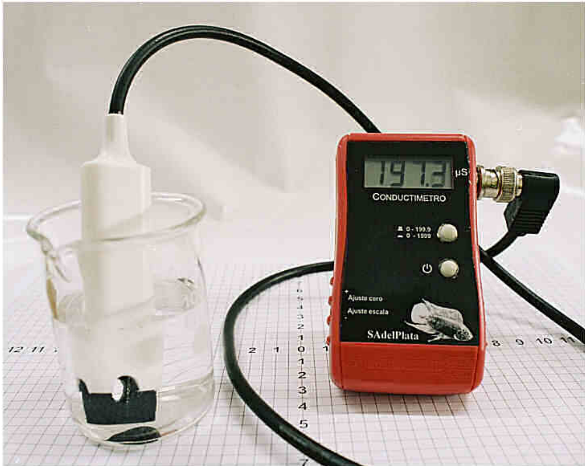
Figura 4: Vista del conductímetro con la segunda celda midiendo agua tomada del grifo. Notar los orificios realizados a la celda para permitir que el aire escape al sumergir la misma en agua.
