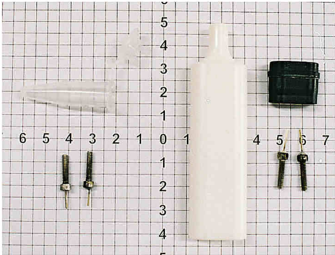
Figura 1: Pueden observarse las partes para contruir las dos alternativas de celda. En la izquierda, la pipeta eppendorf con los dos tornillos de acero inoxidable con los terminales de cobre soldados y a la derecha el exterior del marcador resaltador seleccionado para estructura de la segunda celda. Los tornillos aún no han sido pulidos para eliminar los restos de la soldadura de plata.
