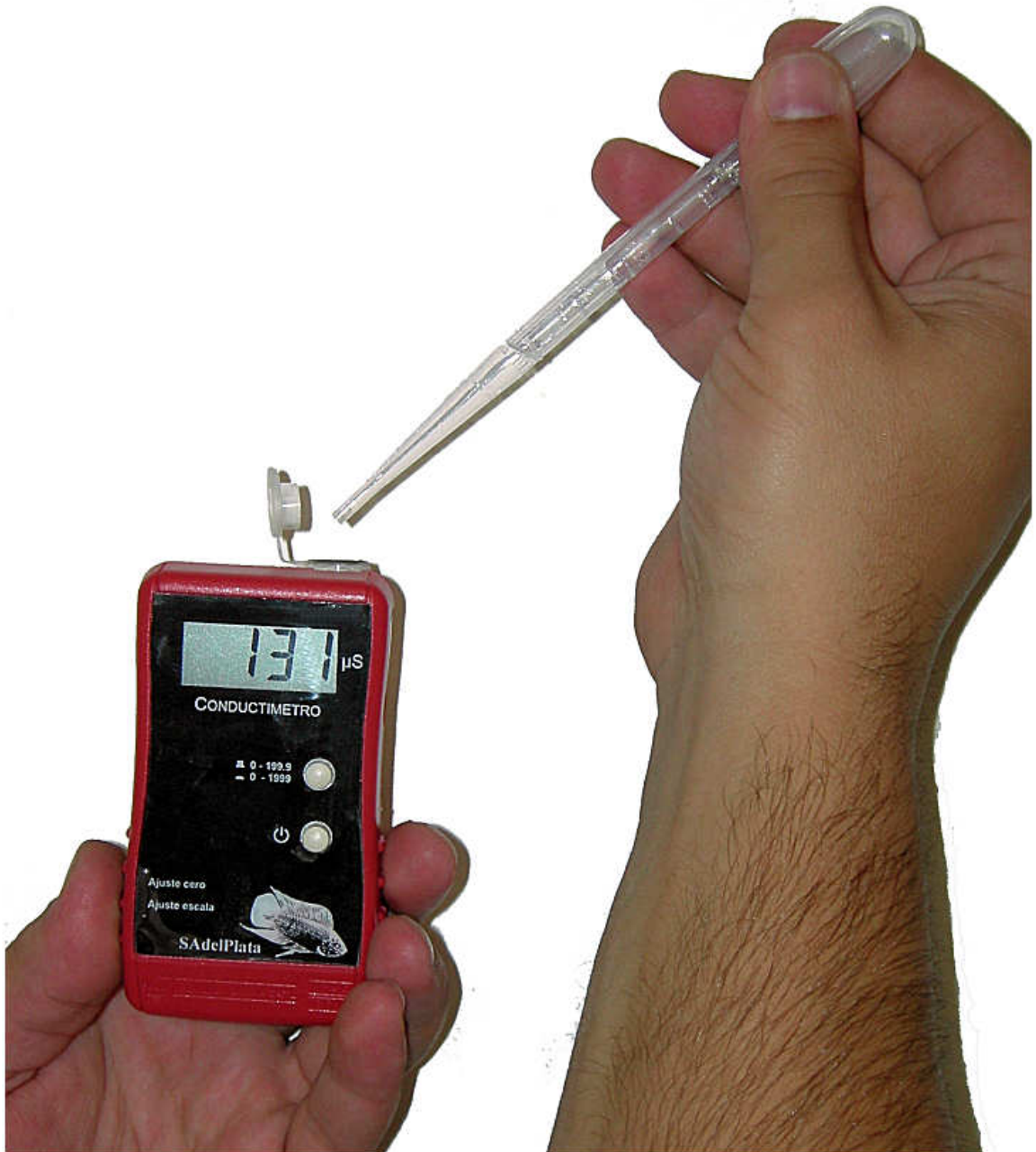
Figura 3: Vista del conductímetro con la primer celda mostrando como se agrega el líquido a medir.
